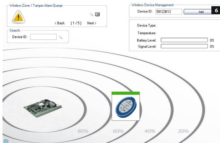
6. После программирования устройства в охранную систему, несколько раз нажмите какую-нибудь кнопку EWK2. При успешном программировании, в программном обеспечении *Eldes Configuration Tool*, в разделе **PC Устройства** появится иконка EWK2, **Уровень Сигнала** и **Уровень Батареи**.
